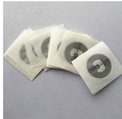
射频识别即RFID技术，可通过无线电信号识别特定目标并读写相关数据，而无需识别系统与特定目标之间建立机械或光学接触。可识别高速运动物流并同时识别多个标签，操作快捷方便。
