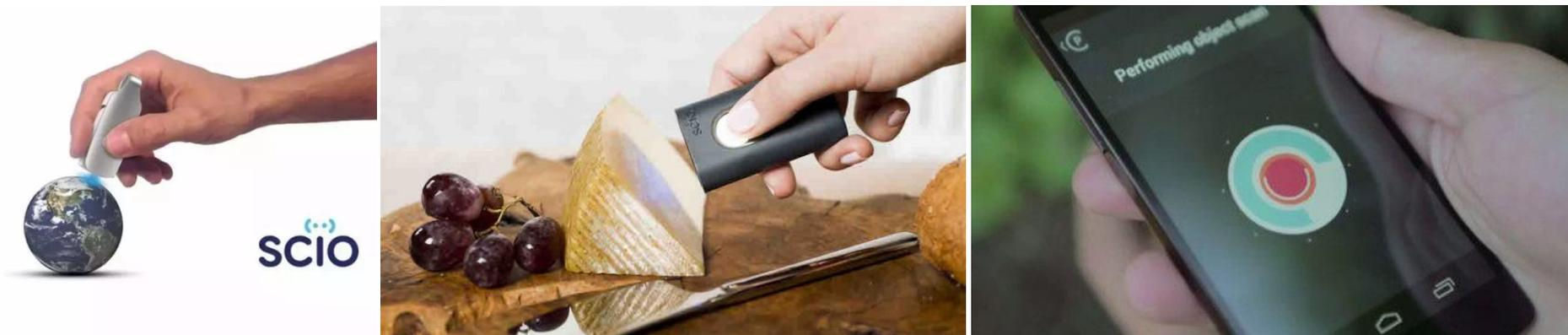
这个SCIO生物扫描仪由以色列一家叫 Consumer Physics的科技公司发明，只要对着食品扫一扫，就能检测出大部分所含的常见化学元素。SCIO 通过蓝牙4.0与 iOS 或 Android 智能手机连接，扫描到的数据会上传到服务器进行分析，几秒钟后就会将分析结果发送到手机上。此外，App中还带有一个DIY 小应用，可以对扫描的材料分析其分子差异。对着苹果扫一扫就能含糖量和卡路里。
