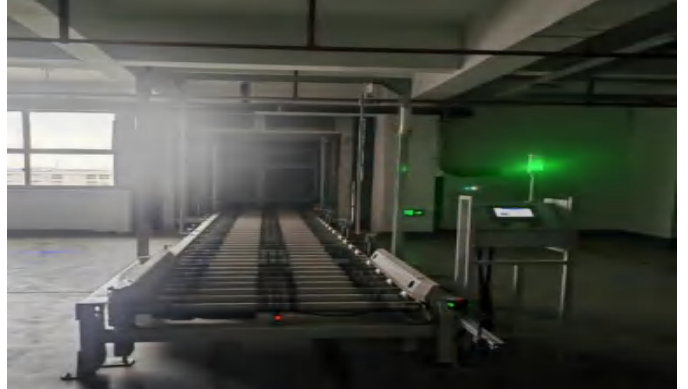
收纸升降台,自动将纸整齐码垛在铲板上
